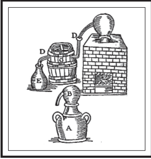
SİMYA İMBİĞİNİN DÜZENEKLERİ, ALCHMICAL STİLL SİMYA İMBİĞİ. (A) BAKIR İMBİK (B) İMBİĞİN KAFASI (C) SOĞUTMA FIÇISI (D) DAMITMA TÜPÜ (E) ALMA KABİ
